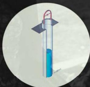
Scavato a mano, rivestito con tubi di cemento armato e perciò più profondo e più ricco di acqua; con imboccatura più protetta e provvisto di sistema per attingerla
